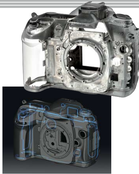
Positionen der wichtigsten Dichtungen, die vor dem Eindringen von Regen, Spritzwasser oder Staub schützen
